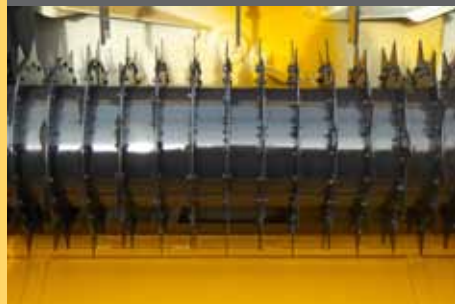
Snijrol met twee motoren (o°)
