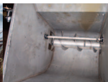
Aangedreven roervijzel voorkomt brugvorming. Le démeleur est entraîné séparément.
