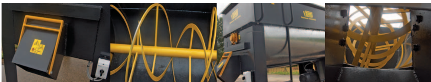
Zijdelingse losklep, manueel te bedienen. Clapet de vidange latéral, Commande manuelle.
