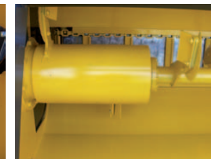
Menger voor gehaksdeld gras 50% van de volume inhoud van de bak, enkel voor type DTMM, DTMG Mélangeur pour herbe hachée 50% du volume du bac uniquement pour le type DTMM
