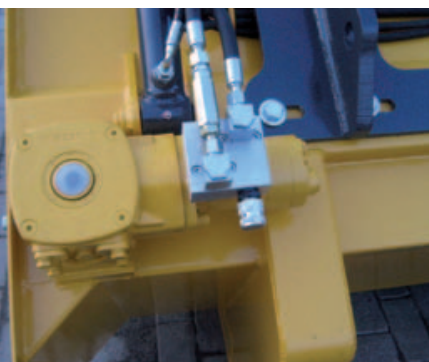
Hydromotor en tandwielkast als aandrijving voor bodemketting. Tapis entraînée par un moteur hydraulique.
