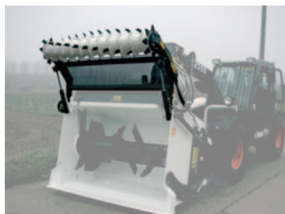
Vaste frees, wegklapbaar voor het opscheppen van los gefreesd voeder (enkel voor type DTMM - DTMG) Fraise fixe, escamotable pour charger l'alimentation fraisée (uniquement pour le type DTMM - DTMG)
