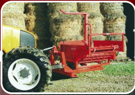
Anbau am Frontheber.
