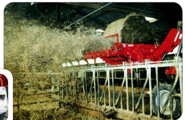
DR180S laterale Position der Zinkenwelle zum Strohverteilen
