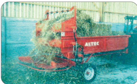
Modell auf Rädern mit Lenkachse (starre Achse auf Bestellung).
