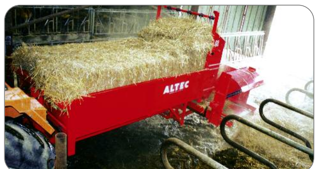
DT120 laterale Strohverteilung in die Liegeboxen, Verteilermaschine auf dem hinteren Dreipunkt
