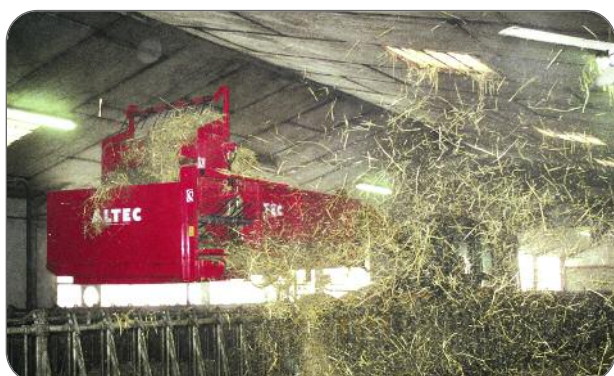
DT120 laterale Strohverteilung über das Futtergitter, Verteilermaschine auf dem Teleskoplader
