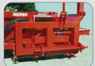
HYDRAULISCHE VERSCHIEBUNG um weitere 20 bis 40 cm zu gewinnen
