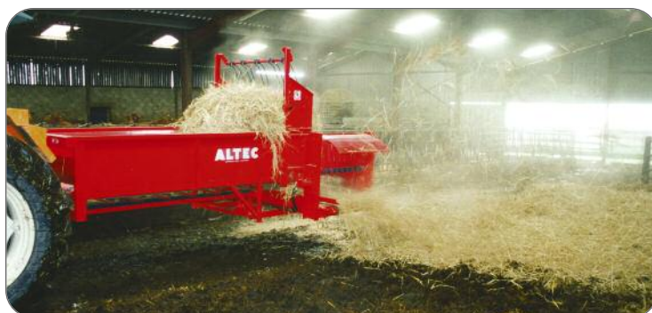
DT120 laterale Strohverteilung in der Stallung, Verteilermaschine auf dem hinteren Dreipunkt.
