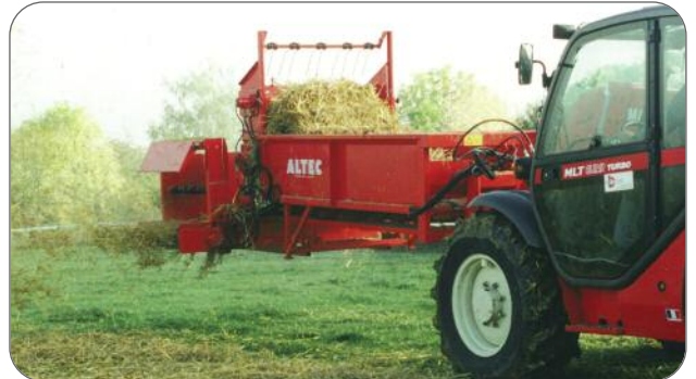
DT120 laterale umgedreht, Strohverteilung nach rechts und nach links + motorisierte Aufladerolle
